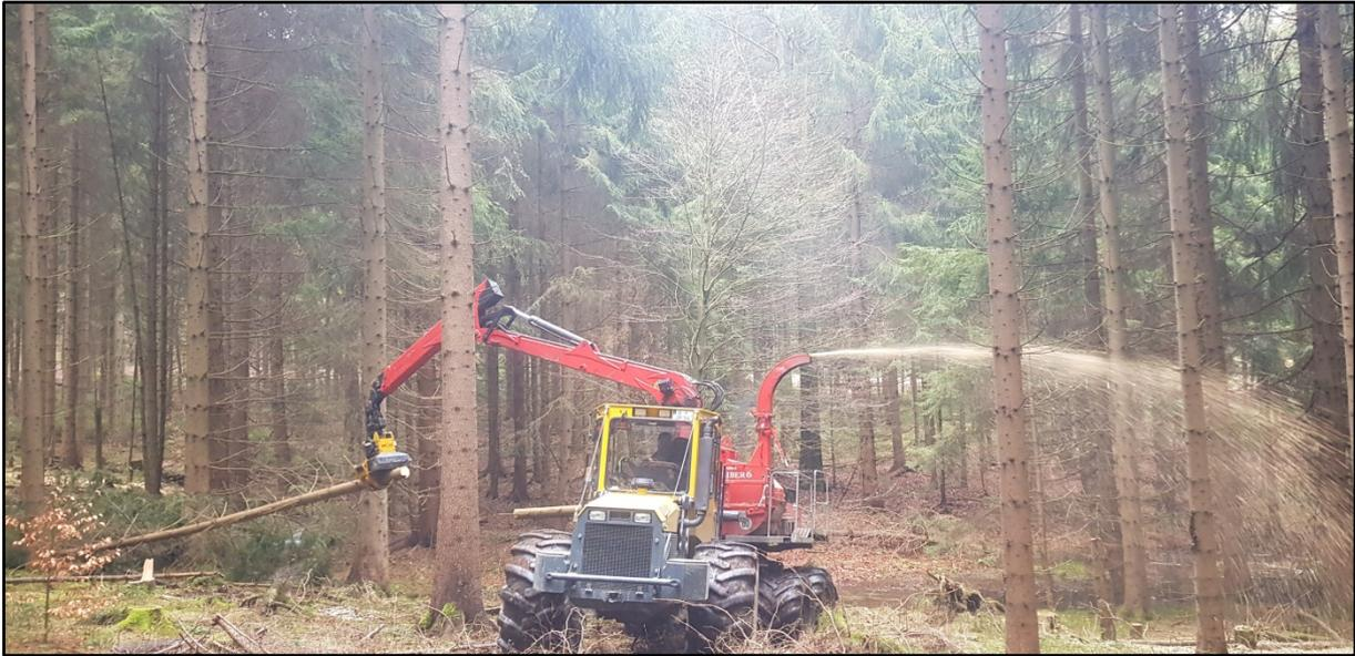
Abb. 6: Spezialtechnikeinsatz einer Mobilen Hackereinheit (Fa. Pöhler) zur Beseitigung von standortswidrigem Fichtenstangenholz entlang der befahrungssensiblen Bachlaufkulisse
