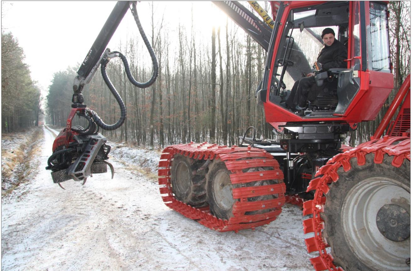
Abb. 3: Harvester der Maschinenstation Königstein mit Bogie- und Einzelradband Terra-X TXL 150 (© Sachsenforst/Leonhardt 2013)
