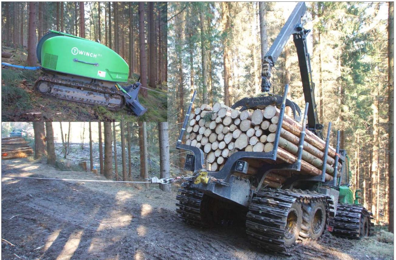
Abb. 6: Externe Traktionshilfswinde „T-Winch“ mit bis zu 6 t Zugleistung (kleines Bild), Forwarder mit kombinierten Bändern (Wechsel von Moorbandplatten und Universalbandplatten, zusätzliche Spikes) © Sachsenforst/Heubaum 2015
