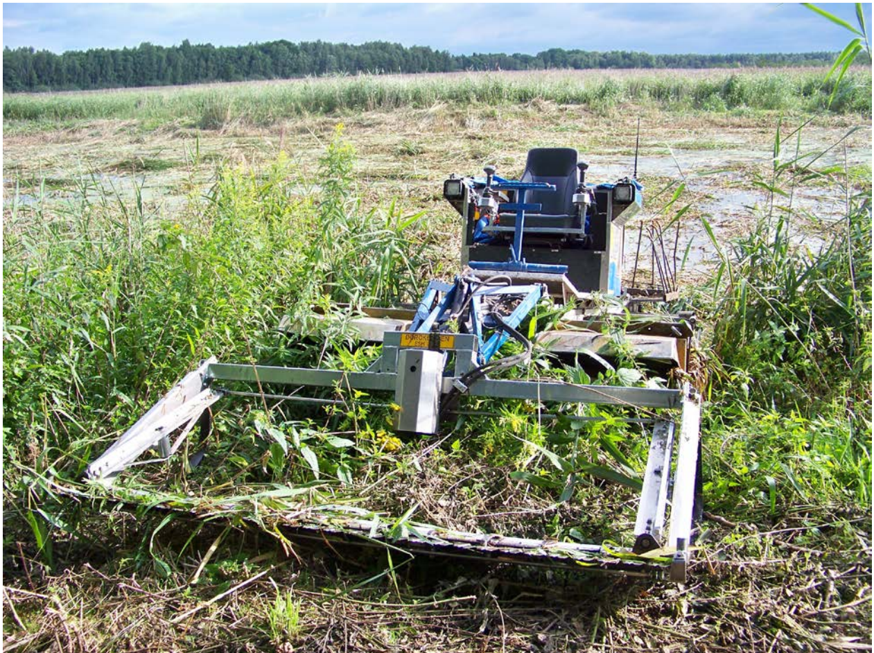
Abb. 21: Ansicht eines am Ufer liegenden Mähbotes (Typ TRUXOR) nach Mahdmaßnahme im Bildvordergrund. Das Mähbot besitzt einen hydraulisch verstellbaren Balkenmäher. Im Bildhintergrund sind die bearbeiteten bzw. gemähten aber noch nicht beräumten Flächenareale erkennbar. Foto: Forstbezirk Oberlausitz (2018)
