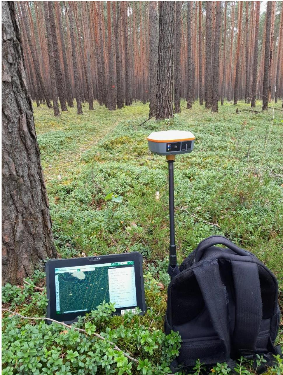
Ausrüstung für die satellitengestützte Suche von Grenzen: Outdoor-Tablet mit Luftbild, Flurstückskarte und Positionsanzeige, welche über den GNSS-Empfänger ermittelt wird.
