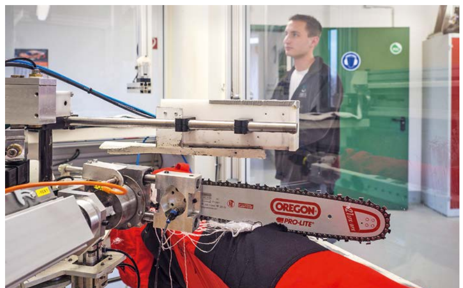
Abb. 1: Prüfung von Schnitzzuschutzkleidung an einem Prüfstand des KWF; Foto: KWF
