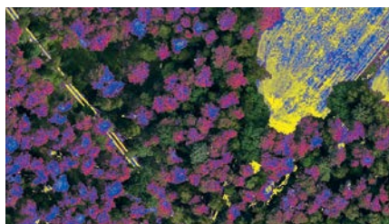
Abb. 3: Aus 5-Kanal-Aufnahmen erzeugte Auswertung der Kronenvitalität mit codierten Farben auf das RGB-Bild aufgelegt; Quelle: GUD mbH
