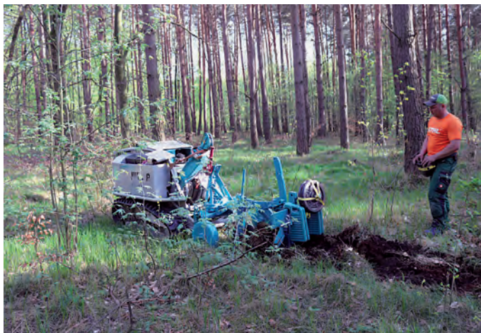
Forstraupe „Moritz“ der Fa. Jassmann aus Grimma mit Streifenpflug zur Bodenverwundung in jüngeren Waldbeständen; Foto: Felix Spittler
