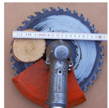
Abb. 4: Freischneidergetriebe mit Hartmetallsägeblatt mit passendem Anschlag und Einsatzgrenze; Foto: Andreas Schwientek
