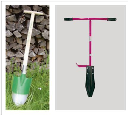
Abb. 2: Hohlspaten (links); Foto: Sebastian Graf; Göttinger Fahrradlenker (rechts); Foto: Grube, Forstgeräte
