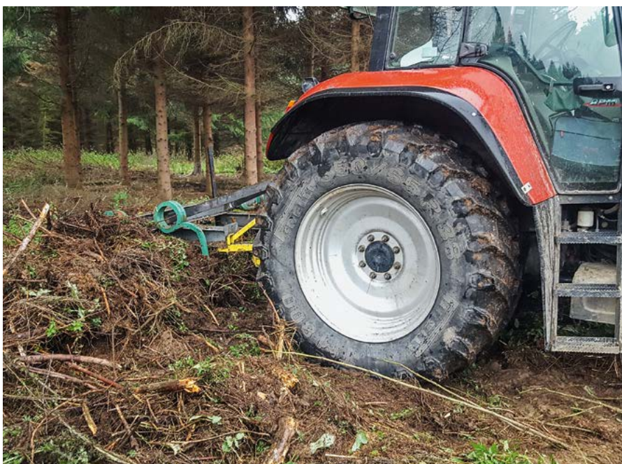
Traktor mit Räumrechnen auf der Schadfläche im Einsatz; Foto: Frank Kämmer
