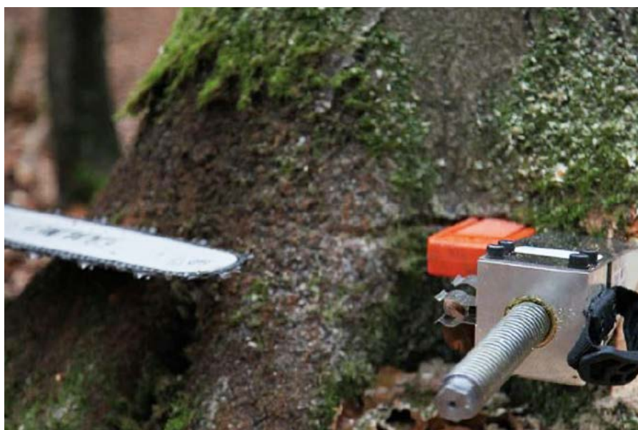
Abb. 1: Kompromiss bei noch nicht anbrüchigem Nadelholz: Erschütterungsfreies Zufallbringen mit mechanischem oder hydraulischem Fällkeil; Voraussetzung ist handwerklich fachkundiges Arbeiten; Foto: SVLFG
