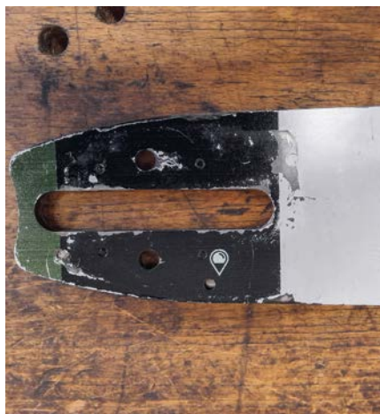
Abb. 3: Öleintrittsöffnung; Foto: Andreas Löbnitz
