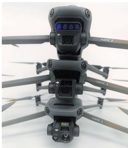
Abb. 2: Unterschiedliche Modelle der DJI Mavic 3 mit Multispektral-, RGB- bzw. Thermalkamera (von oben nach unten); Foto: Dirk Gremser
