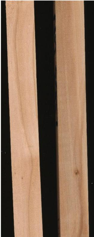
Materialbedingt traten viele Holzfehler auf (Jahrringverlauf, Saugspannungsrisse, Äste) – auch mehrfach an einem Prüfkörper und an annähernd jedem Prüfkörper.
