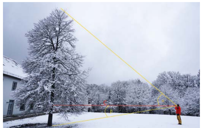
Abb. 3: Höhenmessung durch Winkelmessung; Foto: Kai Sühlfleisch
