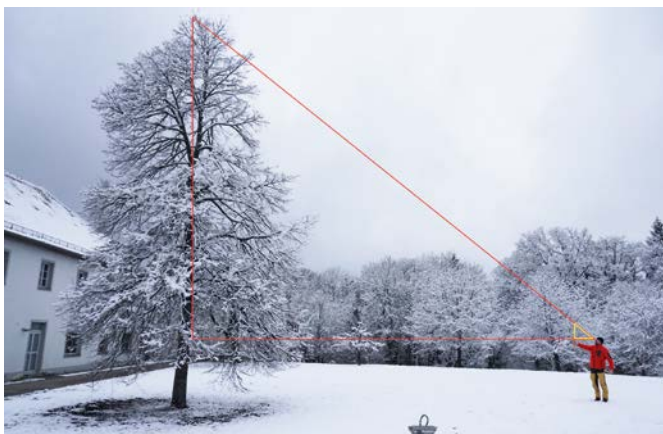
Abb. 2: Höhenmessung mit dem „Försterdreieck“; Foto: Kai Sühlfleisch
