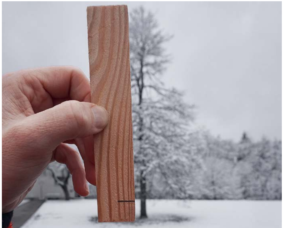
Abb. 1: Holzmessstab mit Zehntelung; Foto: Kai Sühlfleisch
