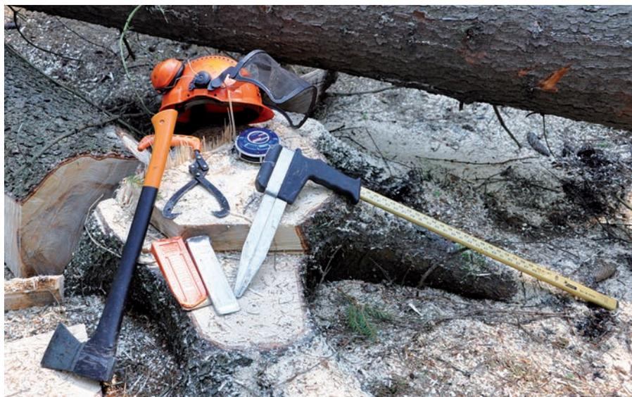
Abb. 10: Handwerkszeug für die Holzernte
