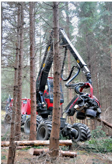
Harvester beim Aufarbeiten einer Fichte
