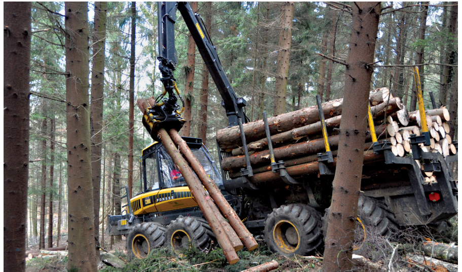
Tragschlepper (Forwarder) nimmt das Holz an der Rückegasse auf und transportiert es zum Abfuhrweg
