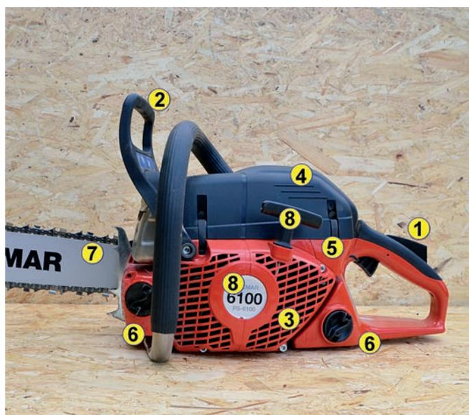
Abb. 1: ① hinterer Handgriff mit Gashebelsperre ② manuelle Kettenbremse ③ Ansaugöffnungen für Kühlluft und ggf. Vergaser ④ Luftfilterdeckel ⑤ Start-Stop-Schalter ⑥ Betriebsstofftanks (Öl und Benzingemisch) ⑦ Schneidsystem (Kette, Schwert) ⑧ Anwerfvorrichtung
