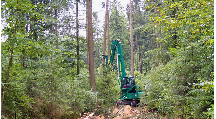
Hanimax „Soft“ der weltweit stärkste Harvester kann Stämme aus dem Bestand heben
