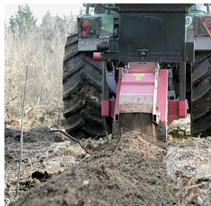
Standardverfahren – Anlage von Frässtreifen mit Kalkeinbringung
