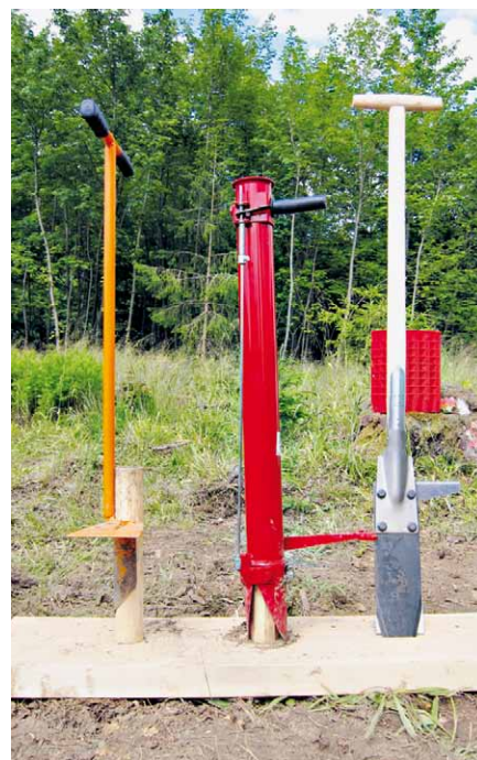
Werkzeuge zur Bestandesbegründung mit Containerpflanzen (links LIECO-Hohlspaten, Mitte Pottiputki-Pflanzrohr, rechts Neheimer Pflanzspaten)
