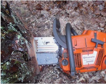
**Fällschnitt durchführen:** Der Fällschnitt wird mit einem Schnitt in Höhe der angezeichneten Bruchstufe begonnen. Nach dem Einstechen in den Stamm, bewegt der Motorsägenführer die Motorsäge in Richtung Fallkerb und steuert genau den markierten Schnittpunkt von Bruchleiste und Bruchstufe an. Um die Parallelität bei der Ausformung der Bruchleiste zu gewährleisten, schaut der Waldarbeiter beim Einstechen in den Stamm von oben auf die Schiene und achtet darauf, dass sie parallel
