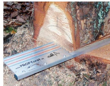
**Fällfahne anlegen:** Nach dem Anzeichnen der Bruchstufenhöhe und der Bruchleistenbreite wird die Fällfahne mit dem Stab in die Fallkerbsehne gelegt. Der breitere Teil der Fällfahne mit den Zähnen wird nun zusätzlich noch etwas in die Stammwalze gedrückt, damit sich ihre Lage beim Einsägen der Motorsäge in den Stamm nicht verändert.
