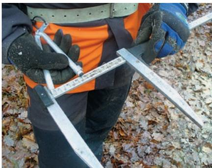
**Bruchleiste und Bruchstufe bestimmen:** Bei einem beispielweise 40 cm starken Baumstamm wird der Zirkel auf einen Wert von 7 cm eingestellt. Dieses Maß erhält man, indem man zur ermittelten Bruchleistenbreite
