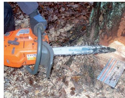
**Schnittführung vorgegeben:** Mit dieser neuen Fällfahne legt sich der Motorsägenführer die Fallkerbsehne quasi neben den Stamm und unter die Motorsägenlehne. Somit kann nun beim Fällschnitt eine möglichst exakte Schnittführung erfolgen.
