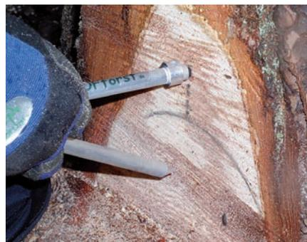
**Schnittpunkt anzeichnen:** Der so entstandene Schnittpunkt markiert für den Motorsägenführer den Punkt der Bruchstufenhöhe. Gleichzeitig kennzeichnet er die Bruchleistenbreite. Dies wiederholt man auch auf der anderen Stammseite, falls der Baumdurchmesser größer als die Schienenlänge der Motorsäge ist. Nun ist die Arbeit des Fällzirkels getan, die erforderlichen Maße für Bruchstufe und Bruchleiste sind am Stamm angezeichnet.
