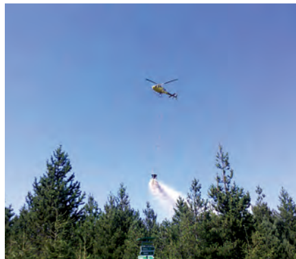
Abb. 1: Hubschrauber bei der Waldkalkung
