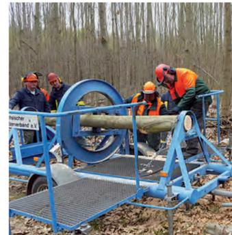
Sägen unter Spannung am Baumbiegesimulator
