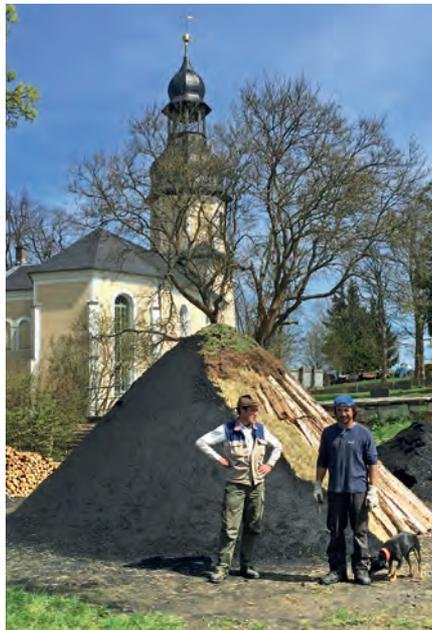
Nach 3 bis 4 Tagen bergen die Köhler die erste fertige Holzkohle. Der verbleibende Holzkegel schwelt unterdessen weiter. Nach etwa einer Woche kommt der Schwelbrand zum Erliegen. Nun ist es Zeit, die Kohle mit Wasser zu löschen, danach abkühlen zu lassen und schließlich in Säcke abzufüllen.
