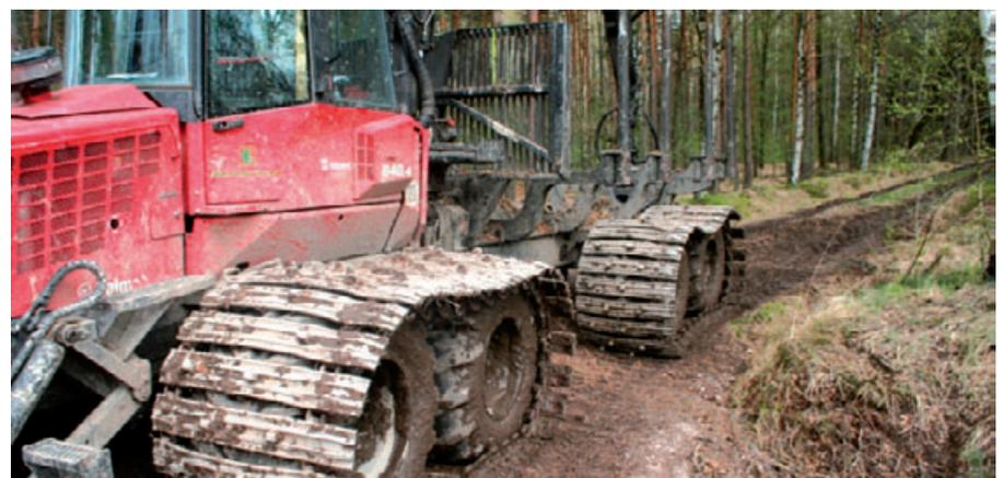
Forwarder (Tragschlepper) mit Bändern bei der Arbeit im Befahrungsversuch
